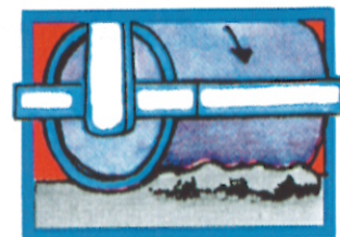
Valcis stumj asfaltbetona maisījumu
