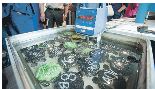
Tiek pārbaudīts asfalta paraugu tilpuma blīvums
