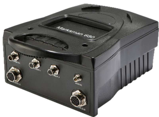
Ilustrācija 4-4. Stacionārā punkta indukcijas cilpu un/vai pjezoelektrisko sensoru darbības SU iekārta
