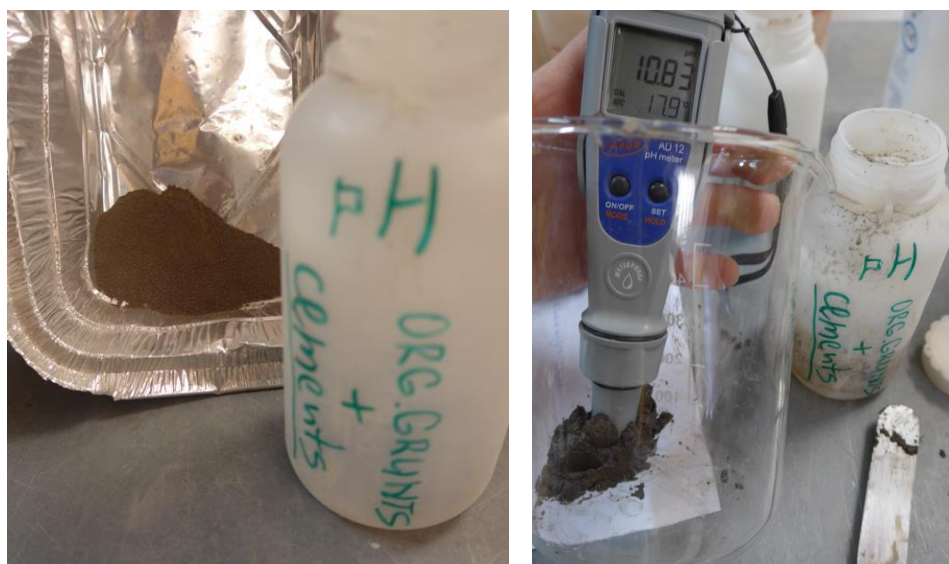
6-3 attēls. Sagatavots grunts paraugs pH līmeņa testēšanai un pH testēšana
