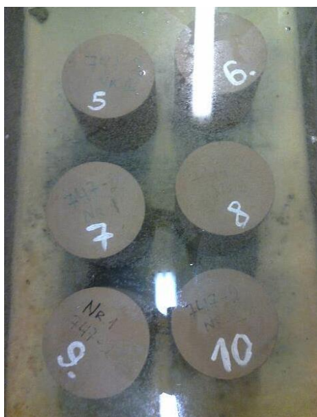
6-10 attēls. Paraugu kondicionēšana ūdenī
