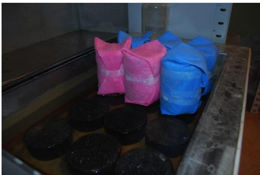
6-14 attēls. Paraugu kapilāra piesūcināšana 24 h
