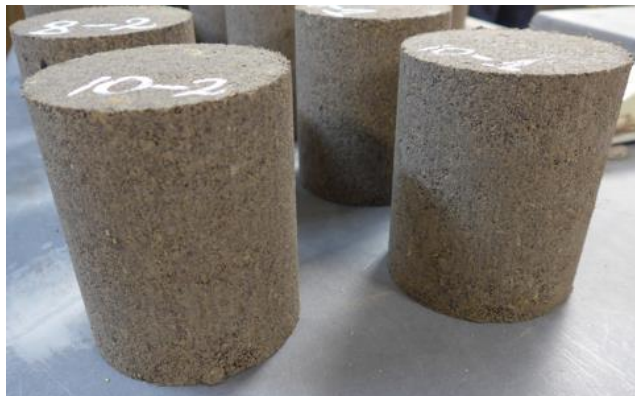
6-9 attēls. Atveidnoti un kondicionēšanai 90-100 %mitrumā sagatavoti paraugi
