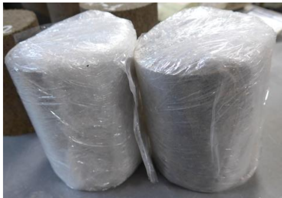
6-9 attēls. Atveidnoti un kondicionēšanai 90-100 %mitrumā sagatavoti paraugi
