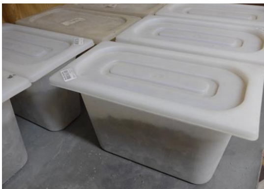
6-8 attēls. Sagatavoto grunts-saistvielas maisījuma paraugu uzglabāšana pēc samaisīšanas pirms paraugu izgatavošanas Proktora veidnē
