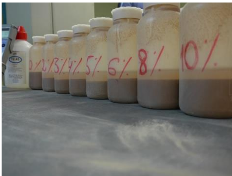
6-12 attēls. Ar dažādu kaļķa saturu sagatavota grunts pH līmeņa testēšanai
