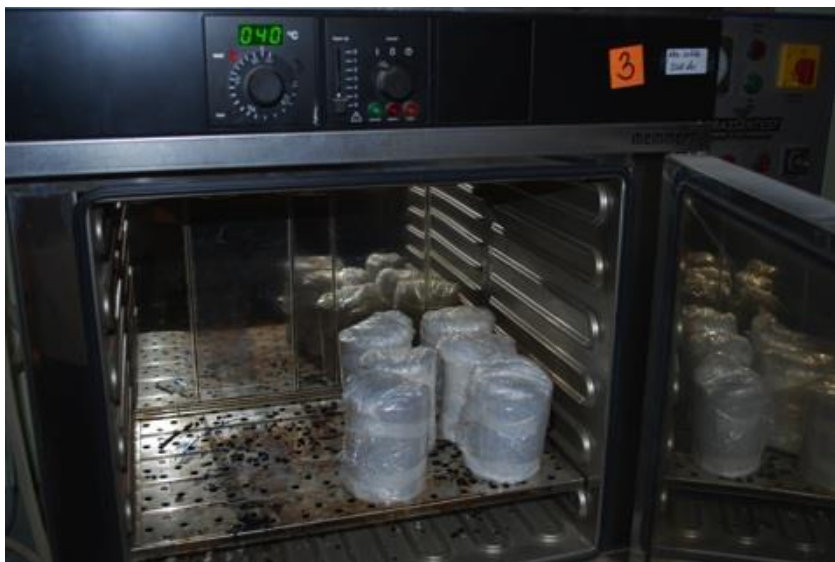
6-13 attēls. Paraugu kondicionēšana krāsnī 40 °C
