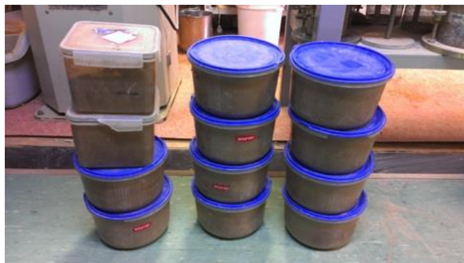
6-8 attēls. Sagatavoto grunts-saistvielas maisījuma paraugu uzglabāšana pēc samaisīšanas pirms paraugu izgatavošanas Proktora veidnē
