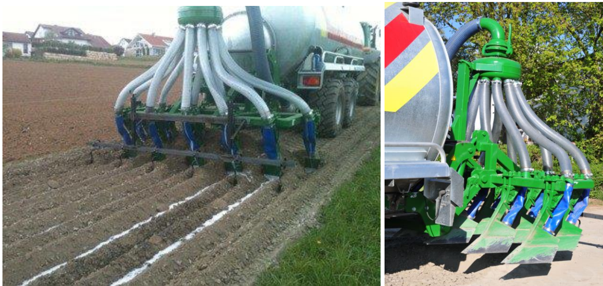
7-19 attēls. Ūdens cisterna aprīkota ar arkliem efektīvai ūdens izliešanai
