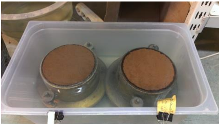
6-7 attēls. Paraugu mērcēšana ūdenī pirms CBR testa
