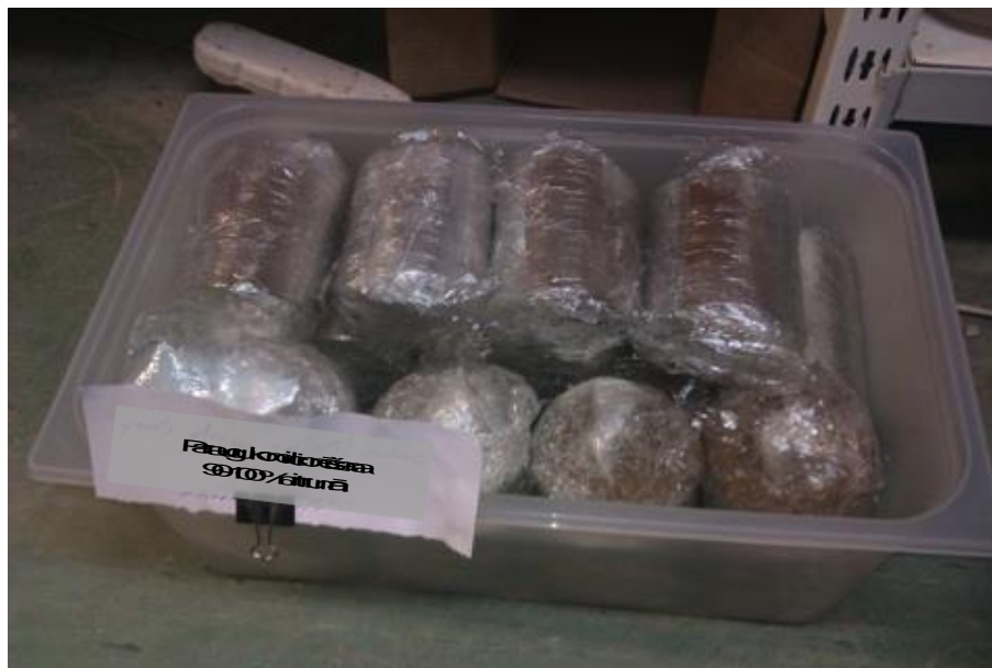
6-5. attēls. Plastikāta plēvē iesaiņoti un ūdenī iegremdēti paraugi
