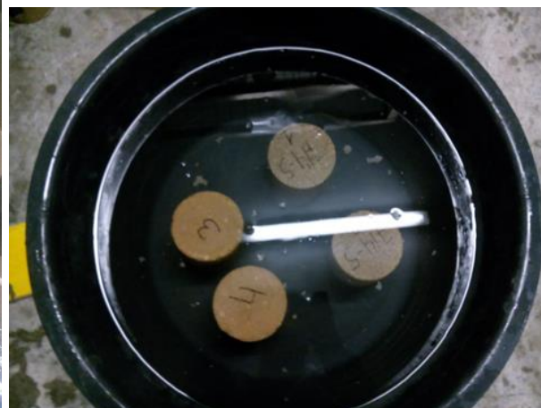
6-6. attēls. Paraugu piesūcināšana ar ūdeni pirms sasaldēšanas/atkausēšanas cikliem
