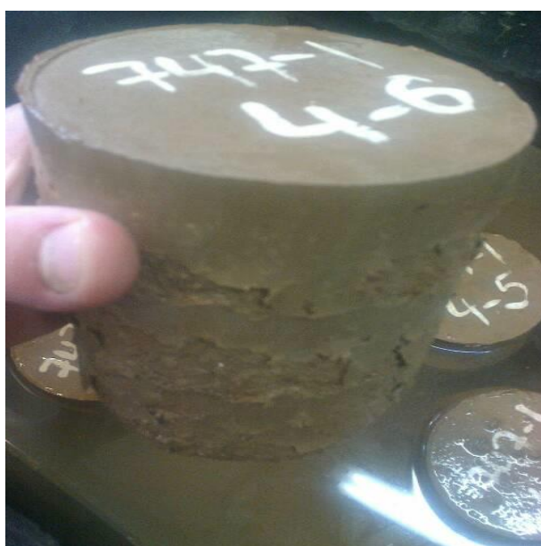
6-6. attēls. Paraugu piesūcināšana ar ūdeni pirms sasaldēšanas/atkausēšanas cikliem
