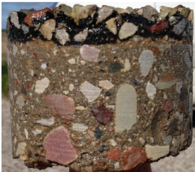
2-1. attēls. Ar cementu pastiprināts smilts-grants maisījums ar virsmas apstrādi
