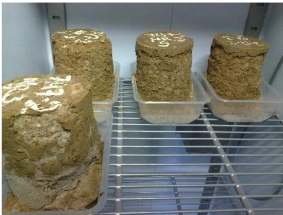
6-7. attēls. Paraugi pēc 28 d. un sasaldēšanas/atkausēšanas cikliem
