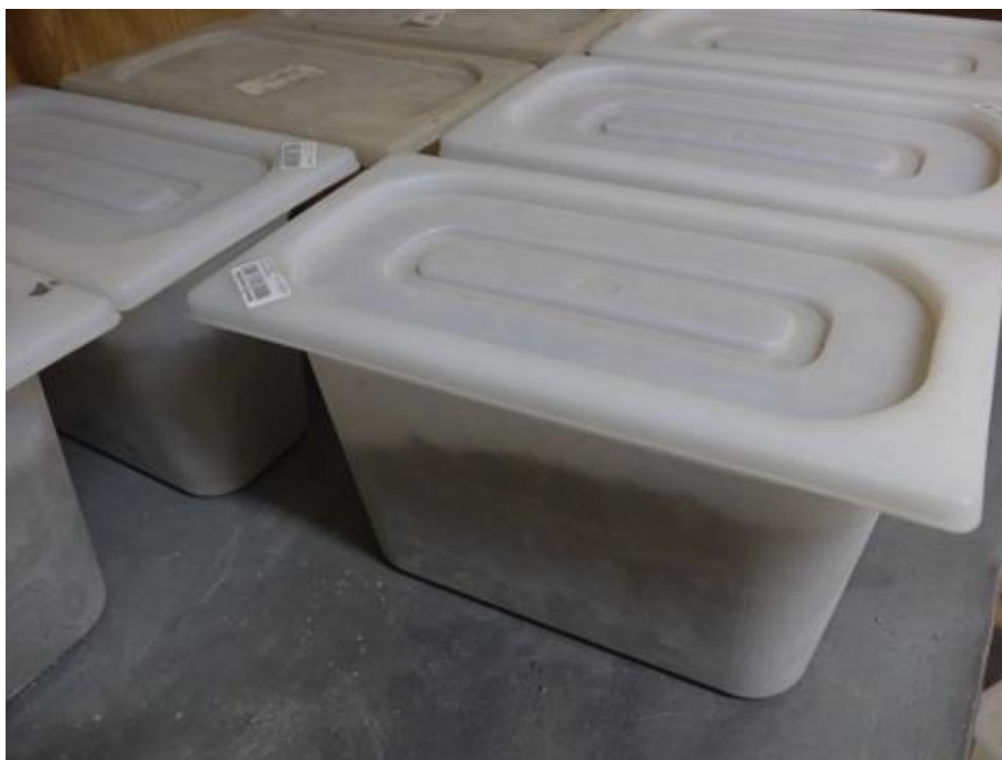
6-2. attēls. Samaisīts maisījums novietots uz 4h pirms paraugu izgatavošanas
