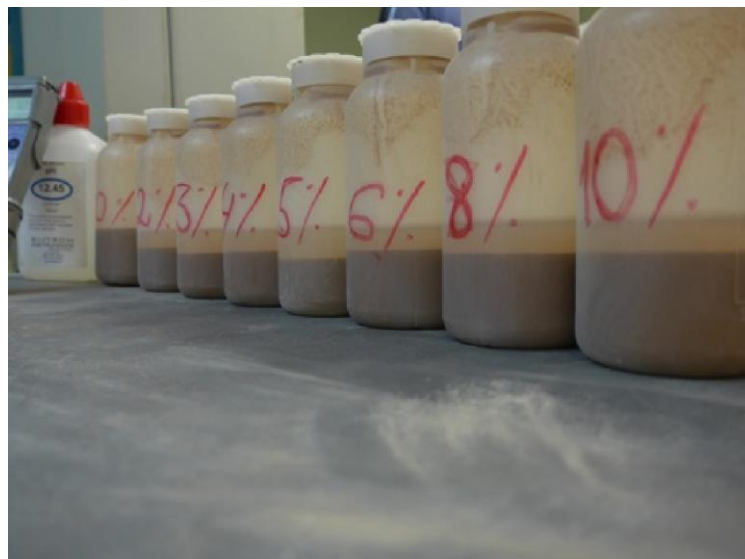
12.7. attēls. Ar dažādu kaļķa saturu sagatavota grunts pH līmeņa testēšanai
