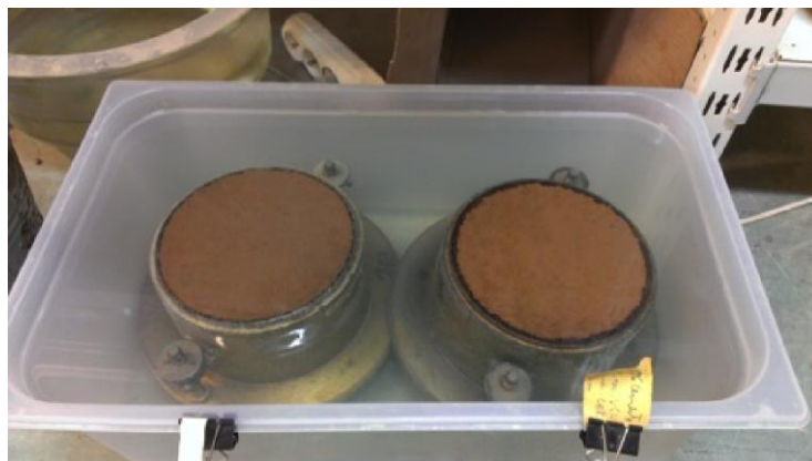
12.2. attēls. Paraugu mērcēšana ūdenī pirms CBR testa
