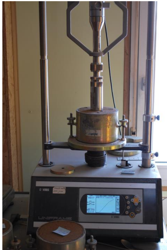
12.3. attēls. TNM vai CBR testēšana
