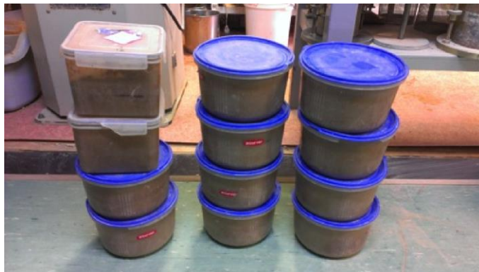
12.4. attēls. Sagatavoto grunts un saistvielas maisījuma paraugu uzglabāšana pēc samaisīšanas pirms paraugu izgatavošanas Proktora veidnē
