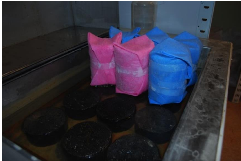
12.9. attēls. Paraugu kapilāra piesūcināšana 24 h
