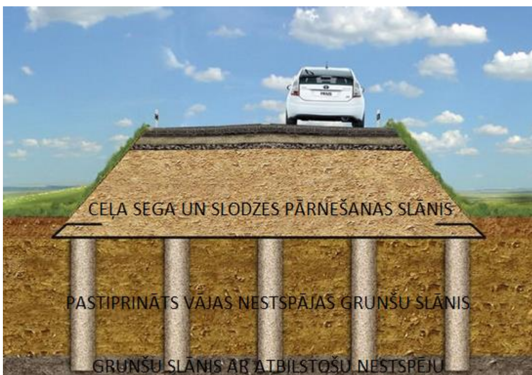
9.1. attēls. Ar dažāda stinguma pastiprinājumiem pastiprināta ceļa uzbēruma shēma
