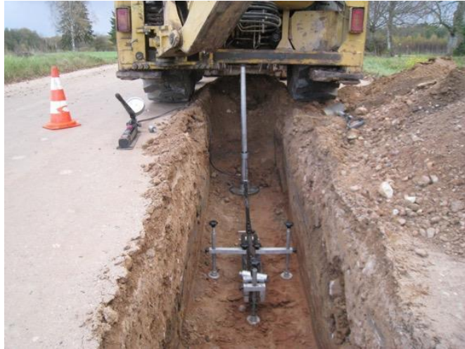
1.13. attēls. Plātnes testa veikšana objektā
