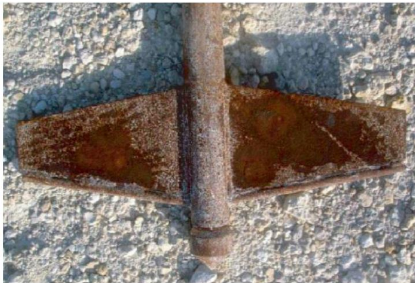
10.10. attēls. KPS spārniņus izmanto, lai novērtētu stabilizētās grunts bīdes stiprību (Garbin and Mann, 2010)
