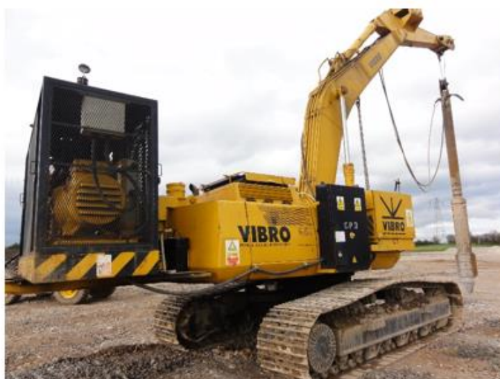
8.7. attēls. Grunts pāļu izbūve ar vibrācijas iekārtu apakšā un minerālmateriāla padošanu no augšas bez ūdens strūklas
