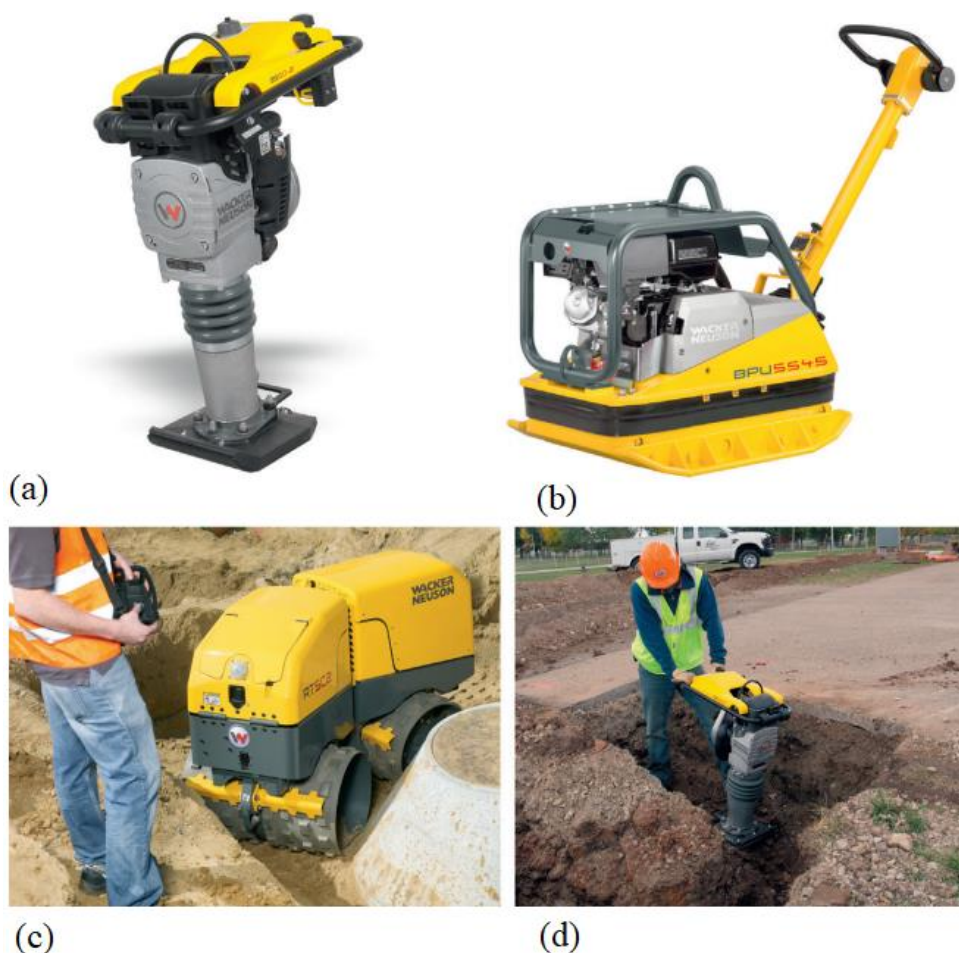
4.7. attēls. Dažāda veida mobilie maza izmēra grunšu blīvēšanas mehānismi (a) – vibrokāja; (b) – vibropliete; (c) – tāl vadības mini veltnis; (d) – vibrokājas pielietojuma piemērs uz lauka [27]
