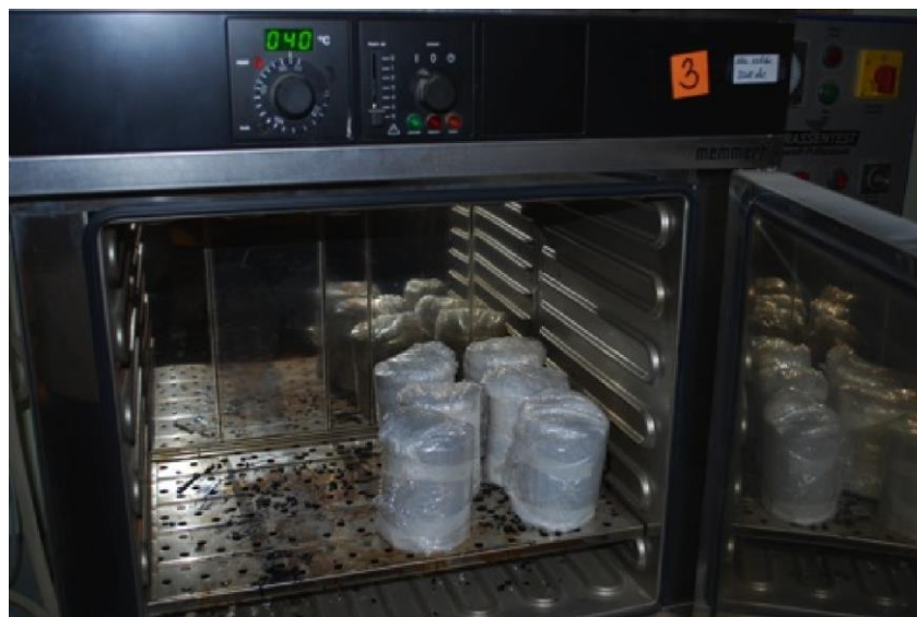
12.8. attēls. Paraugu kondicionēšana krāsnī 40° C
